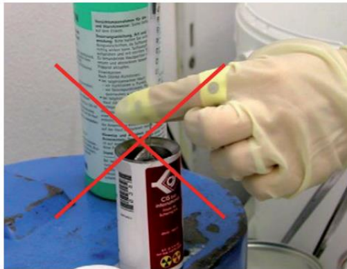
Abbildung 5a: Das Aufziehen der Aktivität ohne Spritzenabschirmung kann an den Fingern zu sehr hohen Expositionen führen.
